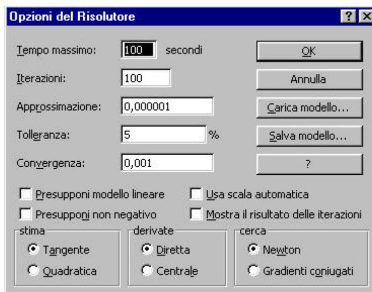
Figura 45 - La finestra di dialogo Opzioni del Risolutore permette di controllare in vari modi la modalità di lavoro del Risolutore per il calcolo delle soluzioni
