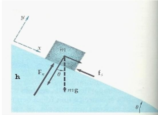
Figura 6.7: Un corpo scivola lungo un piano inclinato.
