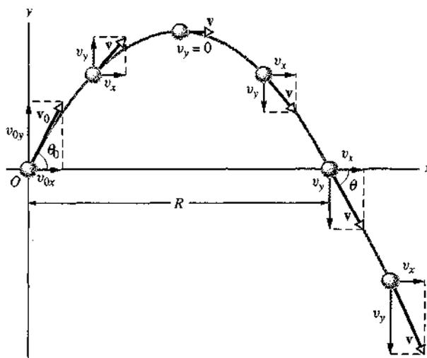
Figura 4.10: Traiettoria di un proiettile. Sono indicate, con le rispettive componenti, la velocità iniziale e le velocità in diversi punti lungo la traiettoria.
