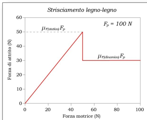
Figura 5.8: Grafico del valore della forza di attrito radente in funzione della forza applicata. Qui  $F_p = 100$  N è la forza di contatto. Si noti il passaggio da attrito statico ad attrito dinamico, coincidente con l'inizio del moto del corpo.
