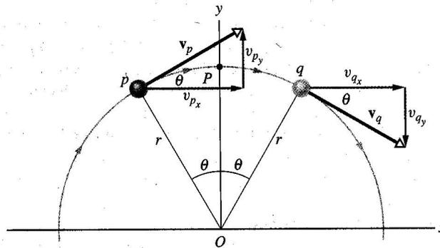
Figura 4.2: Una particella si muove di moto circolare uniforme a velocità scalare  $v$  costante su un cerchio di raggio  $r$ . Sono indicate le sue velocità  $\vec{v}_p$  e  $\vec{v}_q$  e le rispettive componenti, nei punti  $p$  e  $q$  equidistanti dall'asse  $y$ .
