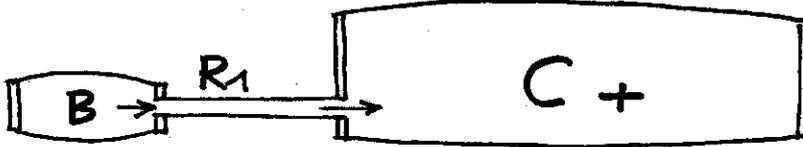
Possiamo ripetere l'operazione con questo "compressore manuale" fino ad ottenere delle pressioni eguali in B e C. Allora la pressione creata in C sarà massima. Diremo che la CAPACITA' C sarà al suo stato di TENSIONE MASSIMA POSITIVA.
