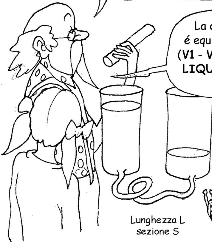
La differenza delle pressioni ( $P_1 - P_2$ ) è equivalente alla differenza di potenziale ( $V_1 - V_2$ ), e la portata di questa **CORRENTE LIQUIDA** è equivalente all'**INTENSITA'**  $I$  della corrente elettrica.
